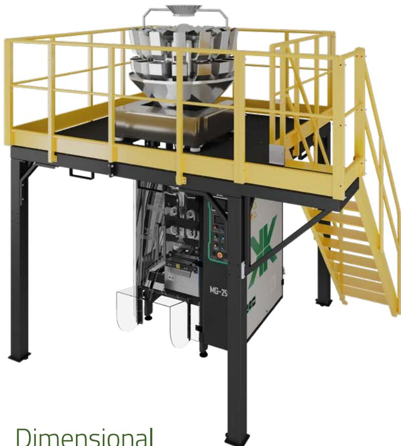
Dosificador indicado para el fraccionamiento de productos de forma irregular o con variación en el peso específico. Además de la variación por el número de balanzas (10 o 14 balanzas), el dosificador puede ser indicado en las versiones de 1,6 L, 2,5L y 5,0 L, con superficies en contacto con el producto, liso o corrugado, dependiendo del producto para ser envasado.
